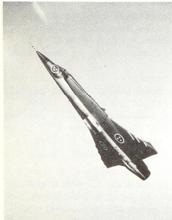
De Zweedse SAAB Draken, uitgerust met een zgn. dubbele delta.
